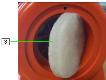
Abb. 88: Filter des Luftkompressors
